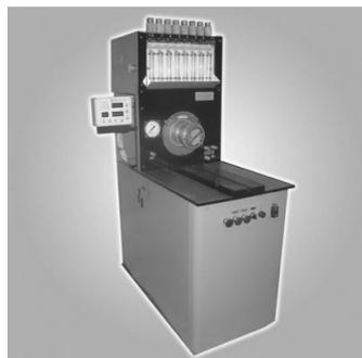
Стенд предназначен для испытания и регулирования топливных насосов высокого давления (ТНВД) с числом секций (линий нагнетания) до 8 с диаметром плунжера до 12 мм.
