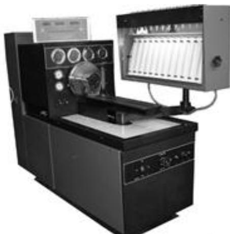
Стенд ТНВД необходим для диагностики, регулировки и испытания ТНВД дизелей типа ЯМЗ-236, 238, 7511, 236 БЕ (НЕ), 236М2, 236А, КамАЗ-740, 7408, ЗИЛ-645, 0550, ГАЗ-5424, 5441, КДЗ-744, Д-65, 260, 64НСП 18/22, 6ДМ-21А, ДГР 200/750, Д-245.12, СМД-31, 31Б, -62, 62АТ, 31/32, А-01М, А-01 МЛ, А-01 МТГ, А-41Е, Д-440, СМД-60, СМД-72, СМД-64 ТНВД типа ТН, УТН, НД, 4УНТМ, ЛСТН. Bosch рядные ТНВД: К, М, MW, А, В, BV, Р. Распределительные ТНВД: Bosch, Lucas, Zexel,
