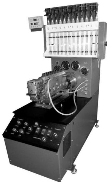
12 секций, электропривод 15 кВт, до 3000 об/мин. Оснащенный электронной измерительной системой БЭСТ-12М, встроенной станцией смазки СМ-1, компрессором, системой термостабилизации.
