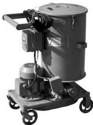
Предназначен для смазывания через пресс масленки под давление 35 МПа узлов трения автомобилей и других машин пластинным смазочным материалом с числом пенетрации не менее 260 и смазочными маслами, а также для заправки смазочными маслами картеров машин и различных емкостей. Передвижной на колесиках, емкость бака на 40 л. или 25 л.
