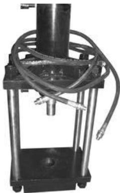
Установка с ручным приводом модели ТТН-60 применяется для выпрессовки (запрессовки) шкворня, оси соединяющей поворотную цапфу с балкой переднего моста без демонтажа передней подвески автомобиля в условиях автотранспортных предприятий и станций технического обслуживания автомобилей. Пресс предназначен для ремонта автомобилей: КамАЗ, МАЗ, IKARUS, MAN, MERSEDES, SKANIA, VOLV, а также других автомобилей с шириной балки 180мм.
