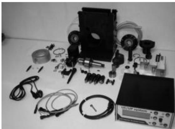
Комплект диагностического оборудования для тестирования и регулировки насос-форсунок дизельных двигателей состоит из электронного тестера (EUI/EUP Tester) и распределительной механической системы (Cambox).
