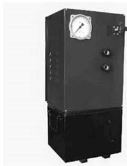
Смазочная станция ДД3100 предназначена для обеспечения условий смазки при испытании на стендах серии ДД-10 ТНВД с циркуляционной системой смазки. При испытании ТНВД с циркуляционной системой смазки масло от напорного штуцера по трубопроводу подаётся к ТНВД. Слив масла от ТНВД производится по сливному трубопроводу. Давление масла регулируется дросселем. Контролируется по манометру. Применяется масло, соответствующее марке для определённого ТНВД.
