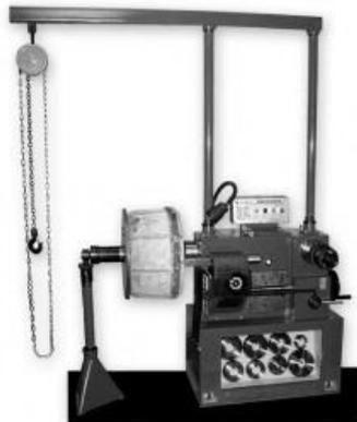
Станок токарного типа с ручным приводом поперечной подачи каретки и с комбинированным (ручным и механическим) приводом продольной подачи суппорта предназначен для расточки тормозных барабанов и тормозных накладок грузовых и легковых автомобилей, а так же для расточки тормозных дисков автомобилей отечественного и импортного производства
