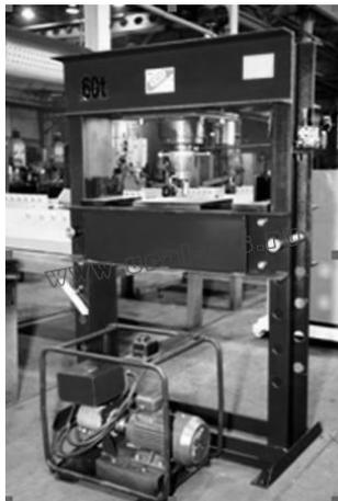
Пресс предназначен для выполнения работ по запрессовке, выпрессовке, правке и гибке. Идеально подходит для монтажа и демонтажа втулок, подшипников, валов. Рабочий стол пресса может настраиваться по высоте.
