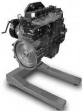
Предназначен для разборки-сборки автомобилей легкого и среднего класса и других агрегатов весом не более 1250 кг в подвешенном состоянии.
