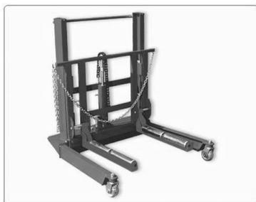
ТГП – 1 Тележка гидравлическая передвижная грузоподъемностью 750 кг предназначена для снятия, транспортировки и установки одиночных и сдвоенных колес грузовых автомобилей.
