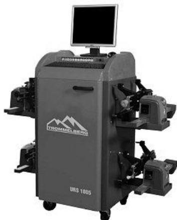
Проводной стенд "развал/схождения" с четырьмя инфракрасными измерительными головками по технологии CCD. На дисплее стенда одновременно отображаются все контролируемые величины.
