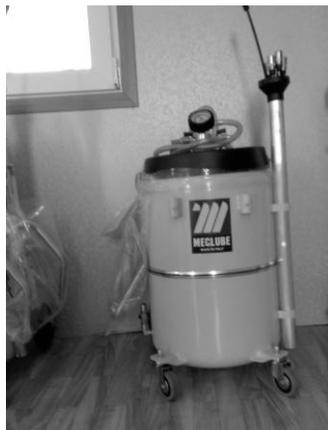
Бак 65 л. с уровнем жидкости, трёх секционная подставка для инструментов, пневматическое опустошение бака (макс 0,5 бар), 9 стандартных щупов. Оборудование может работать автономно после создания вакуума (макс. 0,5 бар).
