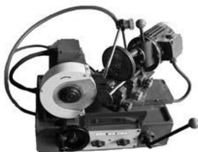
Используется для шлифовки фасок и торцов клапанов.
