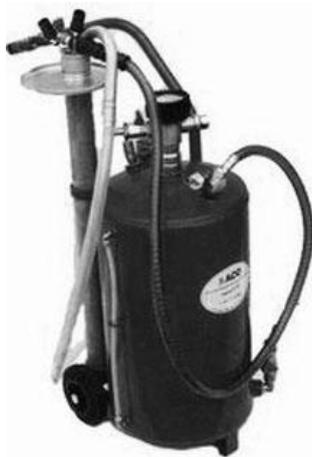
Предназначен для сбора отработанного масла из картеров двигателей с помощью специальных зондов через отверстия масляных щупов (определитель уровня масла), а также для сбора отработанных смазывающих материалов из коробок скоростей, задних мостов, редукторов различных машин и других механизмов в условиях СТО и АТП.
