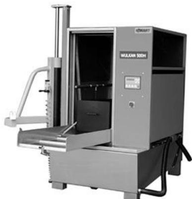
Мойка колес по замкнутому циклу;
