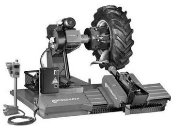
Шиномонтажный станок для коммерческого транспорта. Специально разработанный станок для экстремально больших колёс, имеющих вес до 2,3 т.
