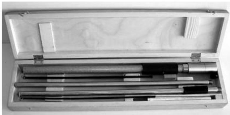
Линейка для проверки схождения колес легковых и грузовых автомобилей с двумя удлинителями.
